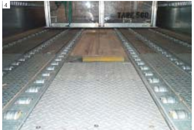
N. 4 - Rulli sollevati per una movimentazione sicura e veloce Lifted rollers for safe and quick handling
