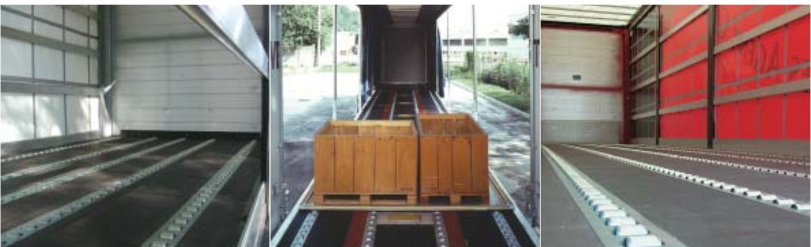
Sistemi di vie a rulli pneumatiche su veicoli per movimentazione pallet aerei Pneumatic roller track system for air freight pallets vehicle loading-unloading
