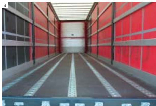
N. 8 - Rulli abbassati durante il trasporto Rollers are down during the transport
