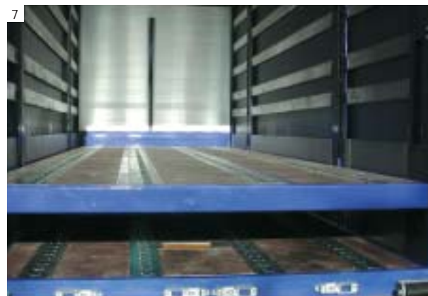
N. 7 - Doppio piano: con vie a rulli e con rulli motorizzati Double deck vehicle: with roller tracks and powered rollers
