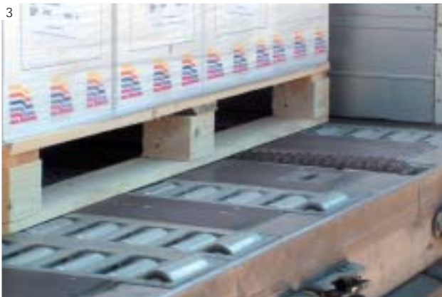
N. 3, 4 - 5 Vie a rulli e due catene: posizione di carico e posizione di trasporto / 5 Roller track and 2 slipchain system: up for handling and down for transport
