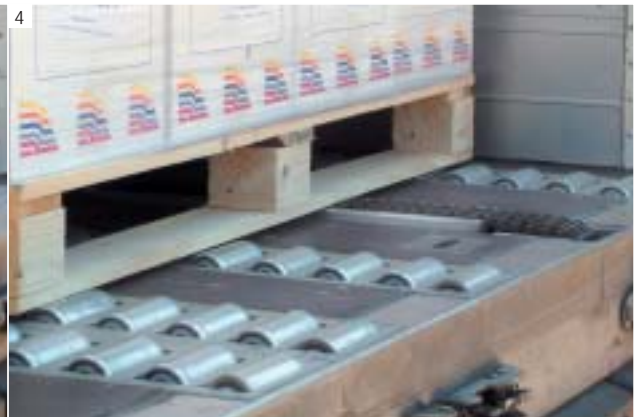
N. 3, 4 - 5 Vie a rulli e due catene: posizione di carico e posizione di trasporto / 5 Roller track and 2 slipchain system: up for handling and down for transport
