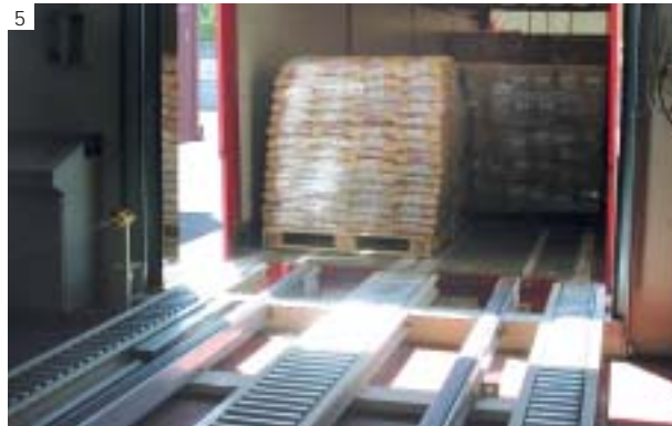
N. 5 - Sistemi integrati di carico-scarico di semirimorchi e banchine Loading/unloading slipchain integrated systems at warehouse bay
