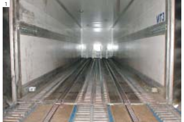
N. 1 - Sistemi integrati di carico-scarico di semirimorchi e banchine Loading/unloading slipchain integrated systems at warehouse bay
